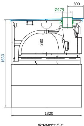
mit Abdeckplatte für Außenbereich und Rauchgasrohr-Adapter
