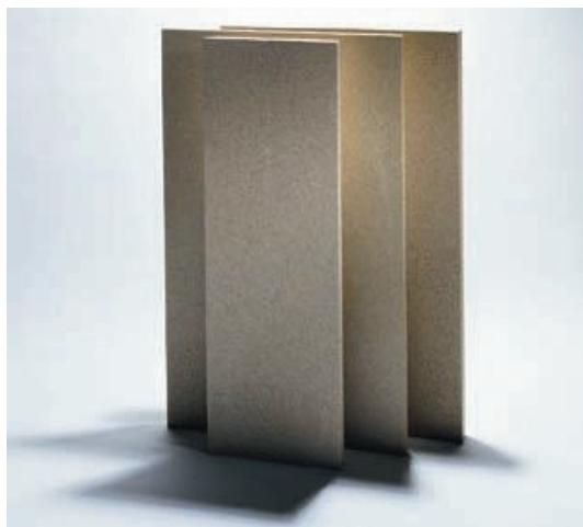
Вермикулитовые плиты являются высокотемпературными энергосберегающими изделиями, предназначенными для работы в условиях с температурой 1100°C. Даные плиты сочетают в себе высокую прочность с низкой теплопроводностью и высокой стойкостью к тепловым ударам.
